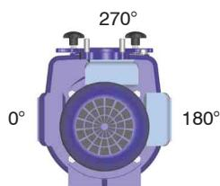
Klemmenkastenlage bei Standardausführung auf den Lüfter des Motors gesehen links (0°).
